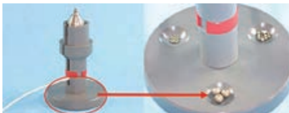
< 플라스틱병등을 안정적으로 측정할 수 있도록 해주는 센서 스탠드, 기준볼을 놓을 수 있는 홈이 있음 >
