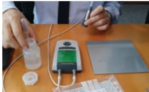
< 측정 모습 - QuintSonic7과 증류수를 이용한 측정 >
