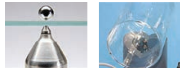
< 높은 반복정밀도와 치수 정도를 얻을 수 있도록 특수 코팅된 기준볼과 SIDSP (Sensor-Integrated Digital Signal Processing) 센서 >
