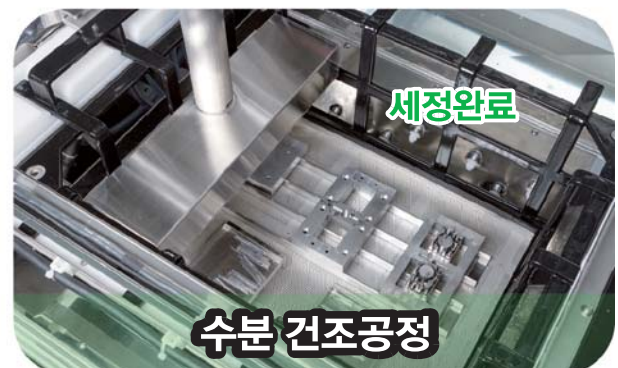
금형에 묻어있는 수분과 잔여 방청제 (COAT-E) 등을 전자동으로 제거하고 물얼룩(건조자국)발생을 막는 공정
