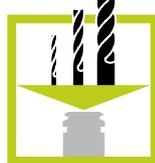
모든 타입 및 재질의  $\varnothing 0.2 - 25.4$  mm 크기 h6 공차의 공구 상크 클램핑 가능 (PG-TAP 콜릿의 탭 및 냉간단조(cold forming) 공구는 h9공차 적용)
