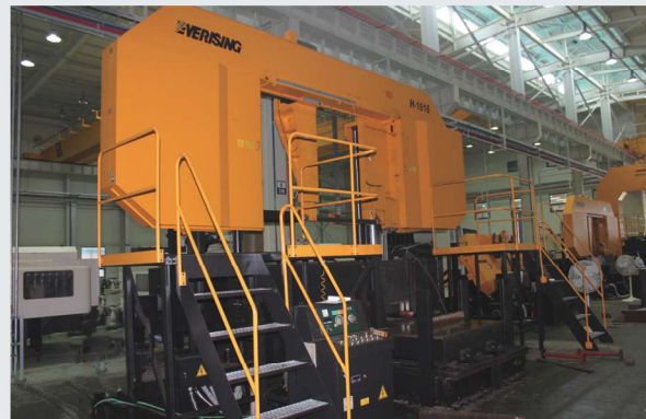
수평형 톱(Horizontal Saw) 설비
