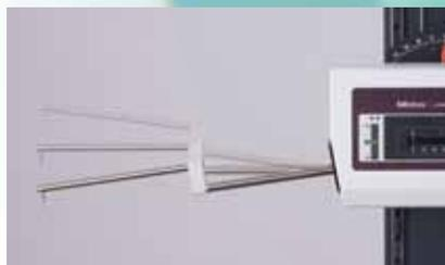
스타일러스 자세 변경, 측정 개시, 정지, 리턴 스위치를 본체 구동부 앞면에 집중 배치함으로써 조작 동선을 대폭 단축했습니다. 측정 때마다 시행하는 조작이므로, 측정자의 피로감 저감과 측정 효율 향상에 크게 기여합니다.
