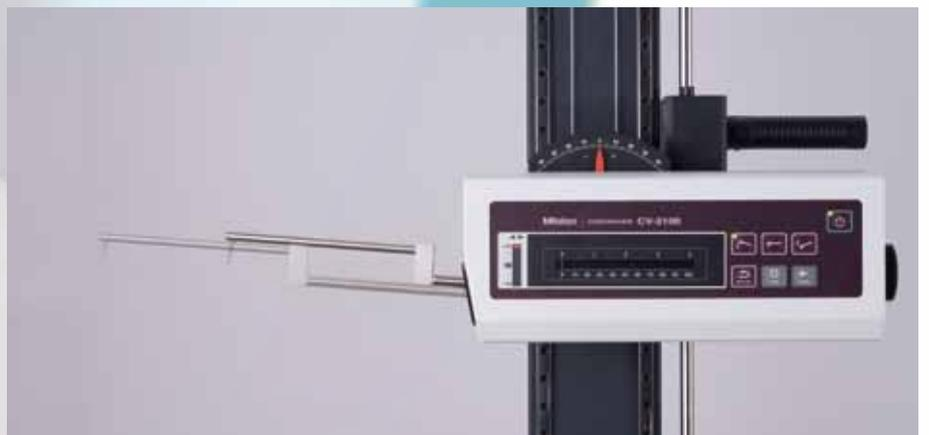
X축의 고속화와 스타일러스 UP/DOWN 기능 강화로, 스타일러스 자동 퇴피 후에 측정 개시 위치로의 신속한 복귀가 가능합니다. 하드 프로그램으로 인한 복수 측정에 커다란 위력을 발휘합니다.
