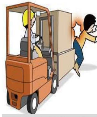
지게차 전방 시야 확보 미흡으로 통행 작업자와 부딪힘
